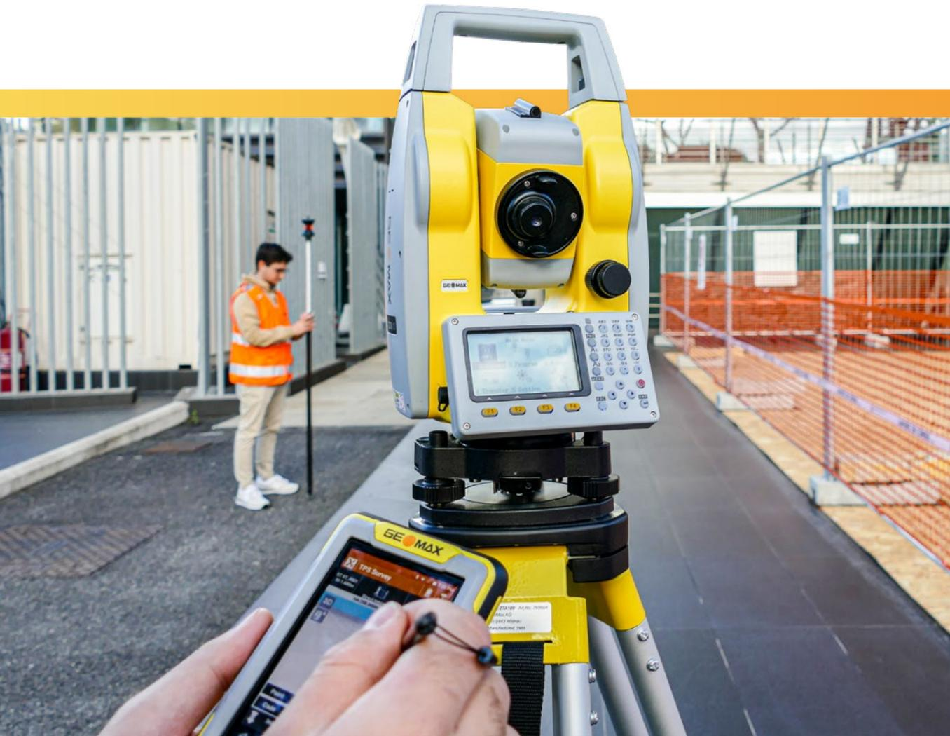
Pour faciliter votre travail, le logiciel embarqué intuitif est exécuté sur deux écrans intégrés. La Zoom10 fournit des mesures sans réflecteur rapides et précises jusqu'à une plage de 350 m et avec une précision angulaire de 2". En association avec le logiciel X-PAD, la Zoom10 améliore votre flux de travail en traitant les données de tout capteur sur une seule et même plate-forme.
