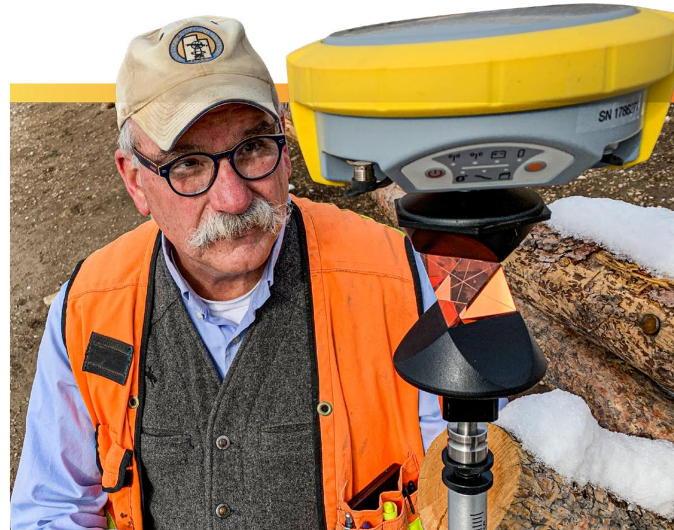
L'intégration de l'X-Pole dans le logiciel de terrain X-PAD permet de basculer entre deux modes de mesure. Passez du mode TPS au mode GNSS en appuyant sur un bouton. Passez facilement sur le mode GNSS si certains points ne peuvent être mesurés en mode TPS par manque de visibilité du prisme. Une fois ces points mesurés, revenez au mode TPS. Cette solution améliore l'efficacité du système en évitant de longues et laborieuses mises sur station.
