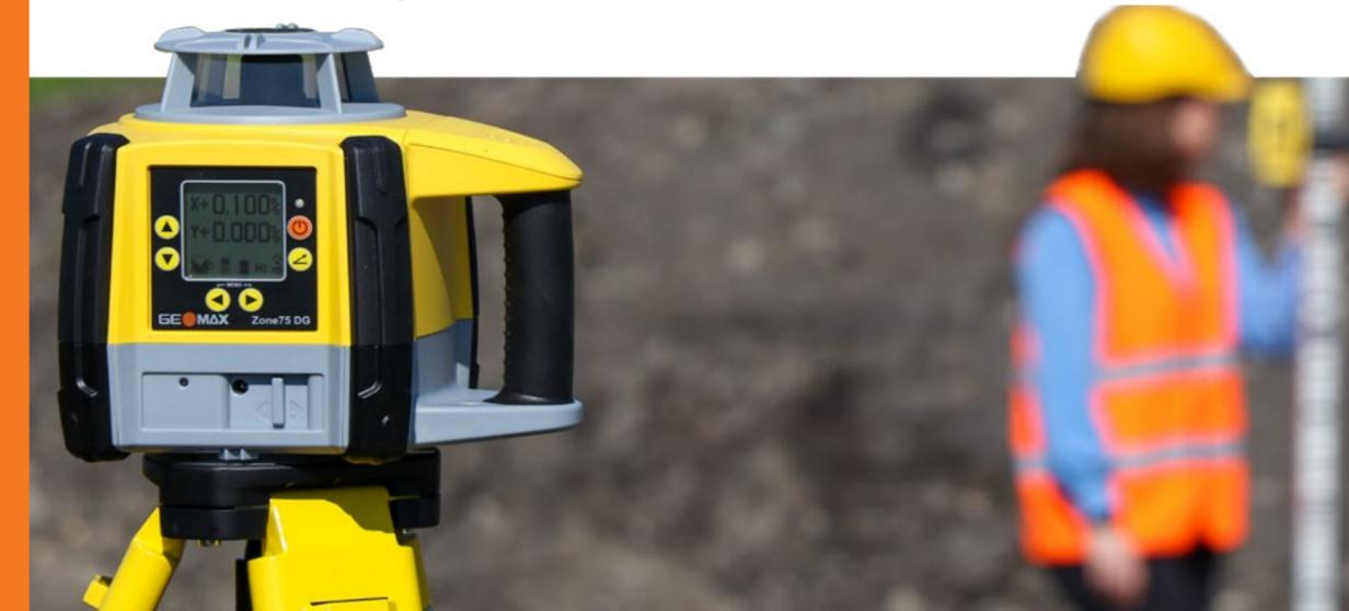
Fonctionnant à une vitesse de 15 rotations par seconde (tr/s), le Zone75 DG est stable sur de longues distances. Le Zone75 DG fournit une référence non seulement pour les plans horizontaux, mais aussi pour les pentes jusqu'à 15 %.
