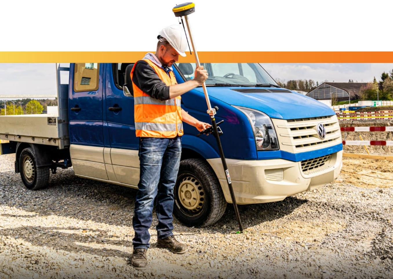
Grâce à la technologie UMI intégrée, vous gagnez en rapidité en mesurant des points inaccessibles par une simple inclinaison de votre antenne. Plus besoin de placer votre canne à la verticale et aucun calibrage n'est à effectuer.
